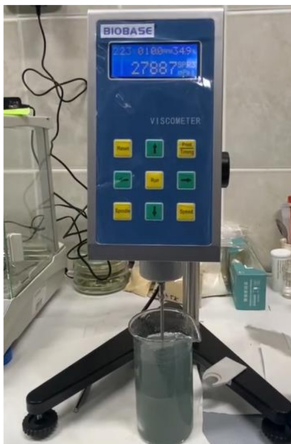
Рисунок 5 - ротационный вискозиметр модели BDV 2C используемый в исследовании реологических свойств гелей
